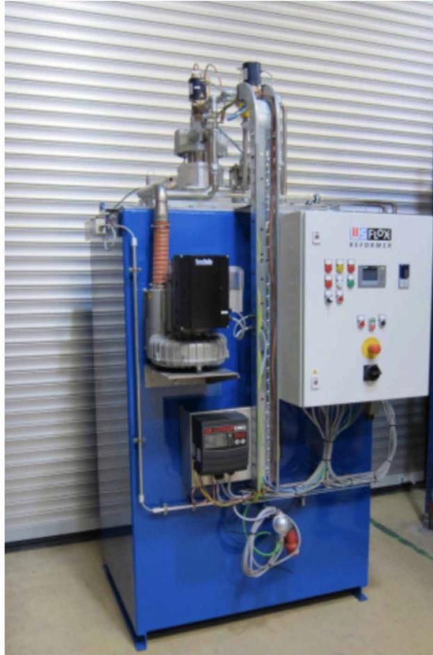
*Abbildung 3 - Ammoniakspalter für die Technikumsanlage*
