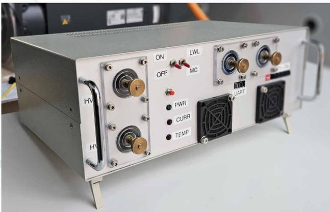
Pulsgenerator mit Spannung bis 2500V und Spannungsteilheit bis 100V/ns
