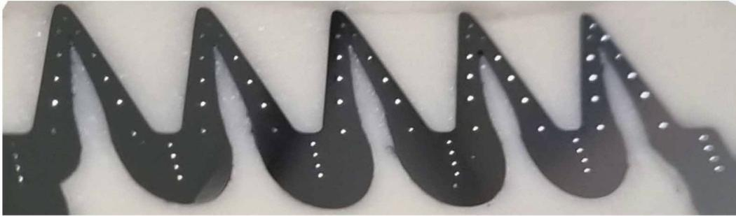
Abb 1: Die galvanisch hergestellten strukturierten Profilkörper mit und ohne Schalleintrag wurden in Epoxidharz eingebettet und getrennt, um metallurgische Untersuchungen daran vornehmen zu können.
