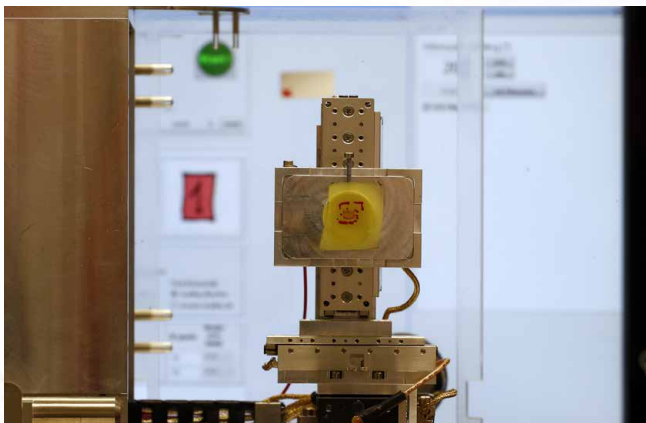
Teil des Aufbaus zur ortsaufgelösten Analyse von Gewebeschnitten mittels Massenspektrometrie
