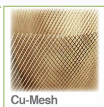
Links: State-of the Art Lageraufbau des Faserverbundbauteils am Beispiel des Flugzeug-Rumpfes. Rechts: Kommerzielle Anwendung von Kupfer-Gittern zur Abschirmung vor Blitzeinschlägen.
